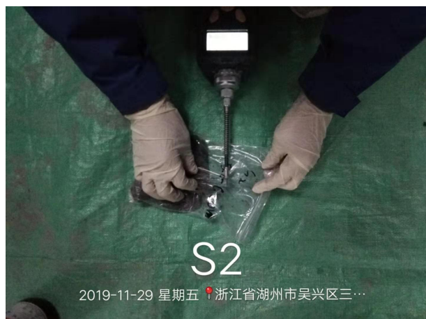
PID 现场检测
