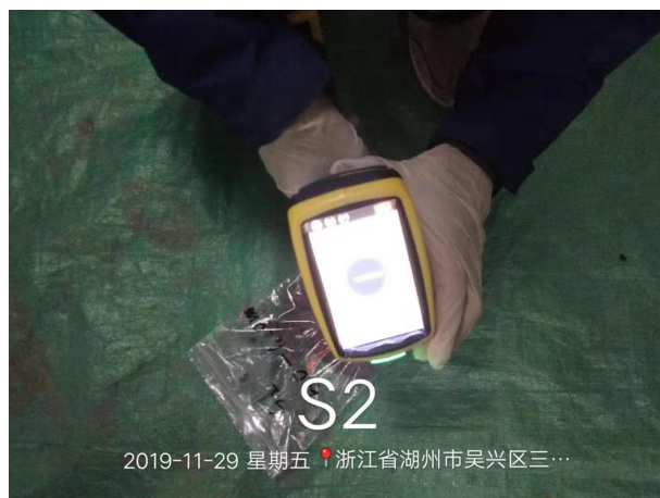
XRF 现场检测
