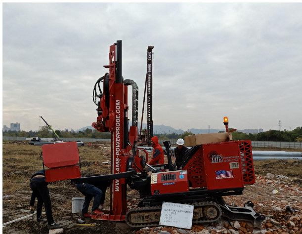
PowerProbe 中空直推式钻孔
