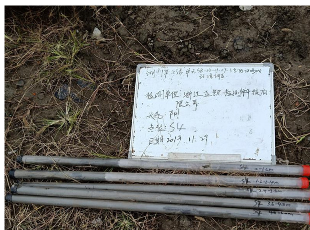
PVC 采样管采集管样
