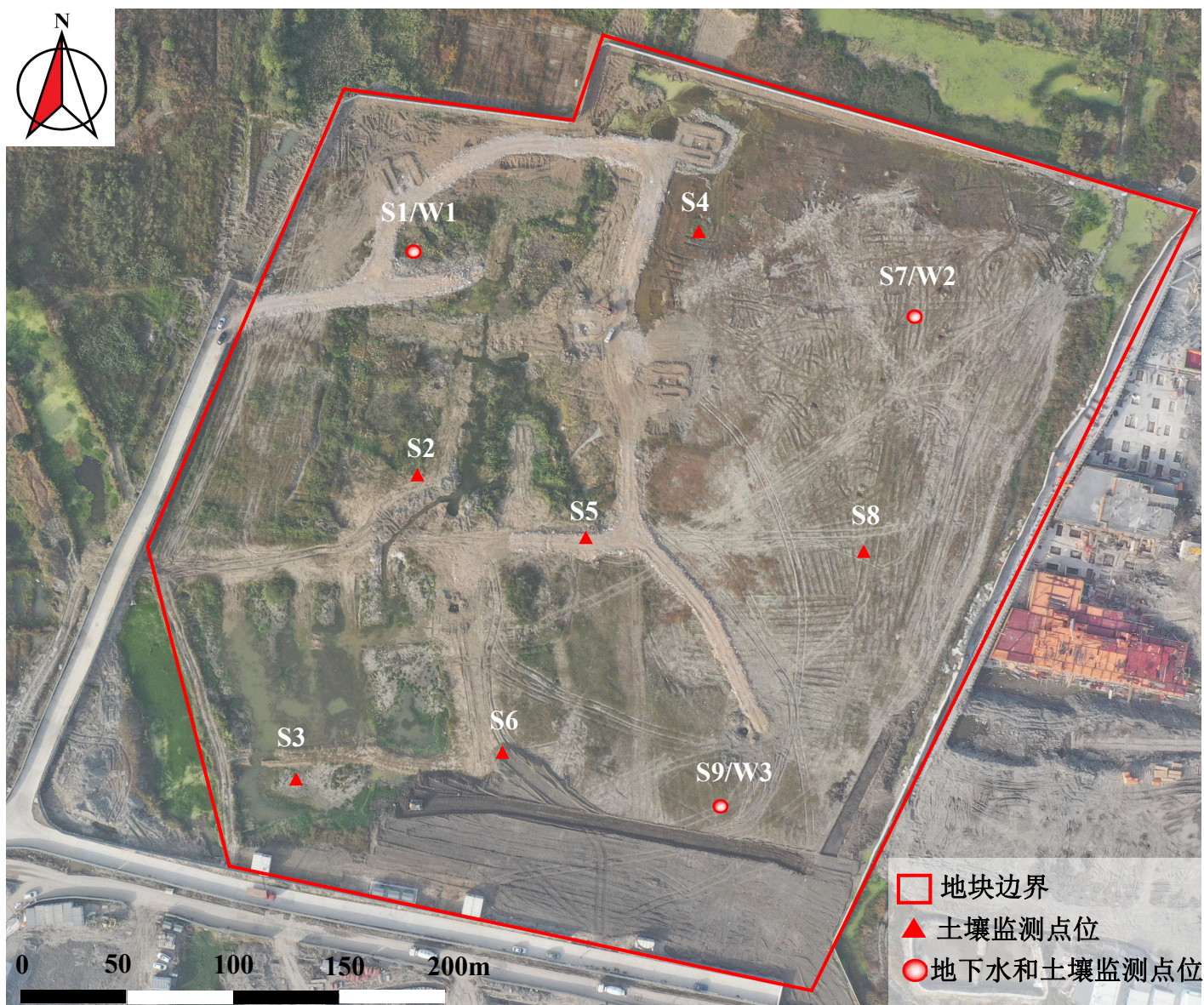
图4-1 草田漾单元SB-04-01-07-3号地块土与地下水监测点位布设图
